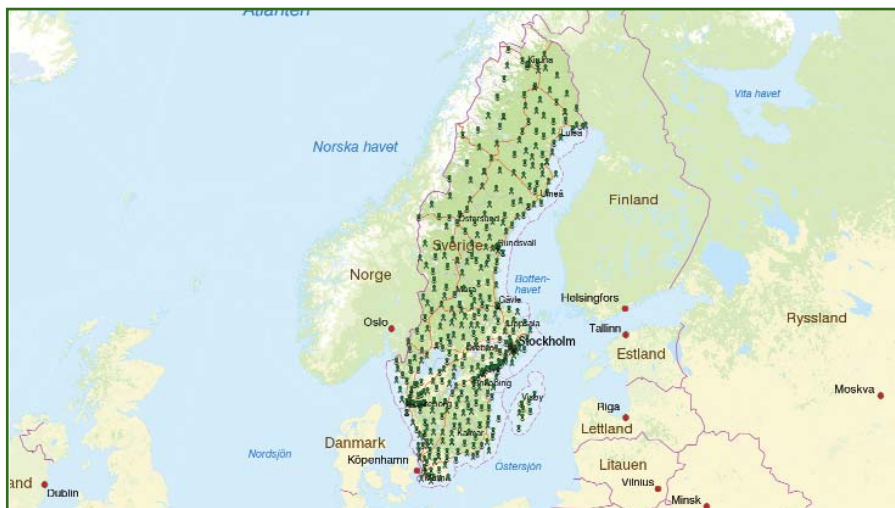
Рис. 3 Станции сети SWEPOS ( https://swepos.lantmateriet.se )
