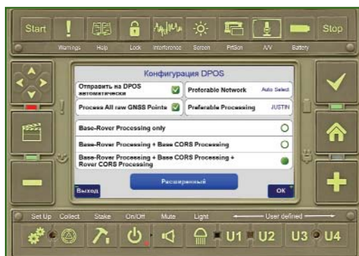
Рис. 5 Настройка алгоритма обработки в режиме Hybrid RTK на приемнике TRIUMPH-LS
